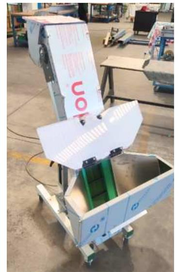
Nastro caricatore per componenti elettromeccaniche
