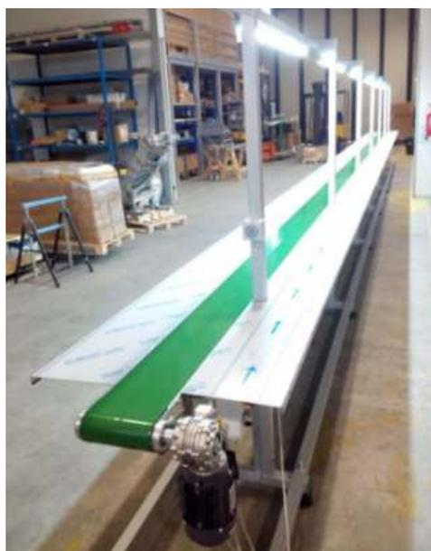
Nastro trasportatore per assemblaggio cosmetici, 15000mm INOX
