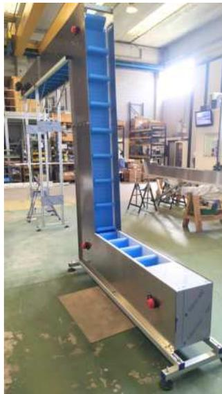
Elevatore in AISI con tappeto modulare
