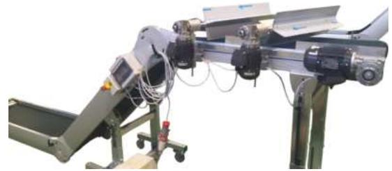
Nastro con separatori, settore trasformazione materie plastiche
