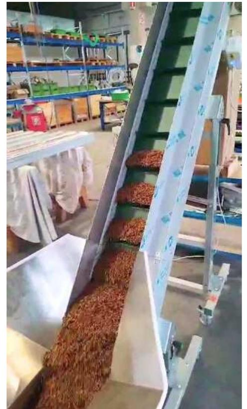
Nastro carico polverizzatore vermi per farine
