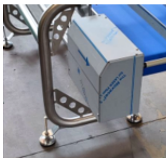
Carter copri motore in acciaio INOX
