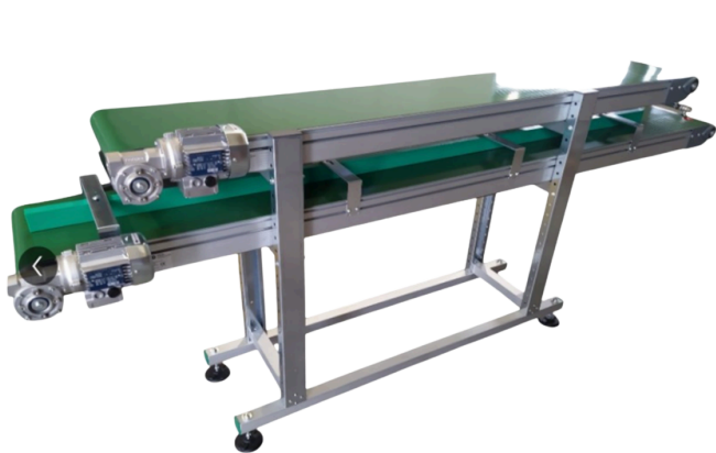
Nastri sovrapposti per asservimento robot
