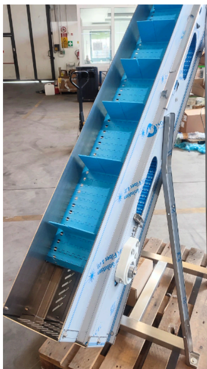
Nastro in AISI con tela modulare per trasporto formaggio
