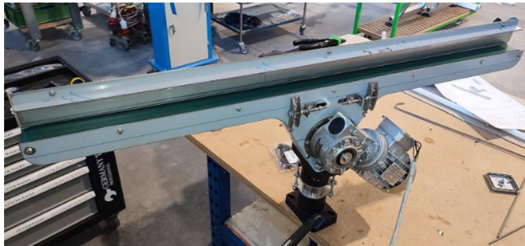
Nastro piano In AISI 1200x40mm-Tela PU Verde integrato in Macchina piega tubi
