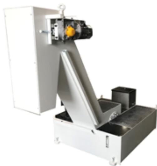
Evacuatore di truciolo raschiante (adatto a trucioli corti di vari materiali) completo di rotofiltro autopulente con rete da 250 micron per il filtraggio automatico del liquido refrigerante.
