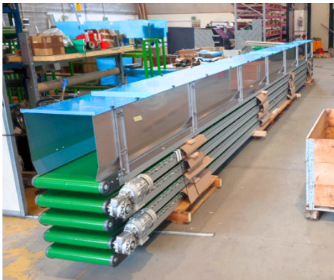
14 nastri piani per un totale di 120mt lineari, trasporto FLACONI sfusi
