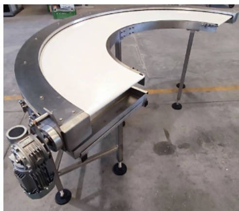
Nastri a tappeto curvi a 180° totalmente in AISI per settore dolciario
