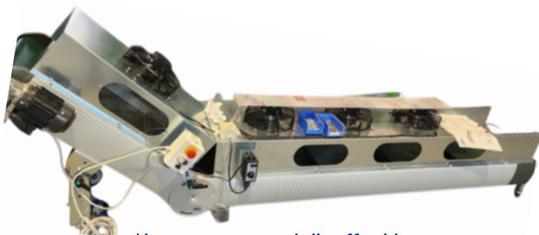
Nastro con tunnel di raffreddamento
