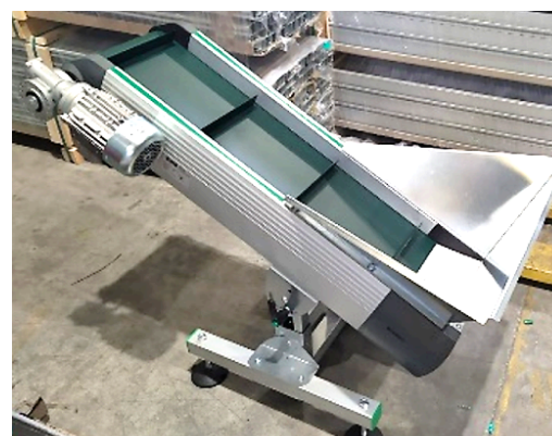
Nastro tramoggia per carico vibratori
