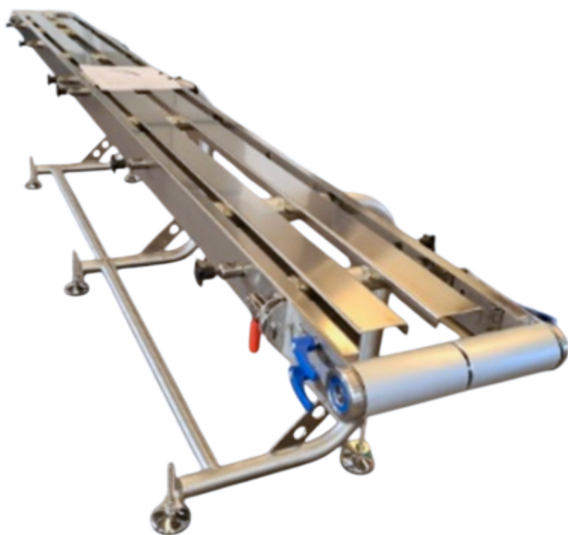
Nastro totalmente lavabile e sanificabile in AISI con sistema sgancio rapido
