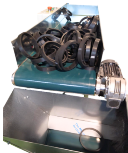
Sistema automatico di allineamento guarnizioni da rinfusa
