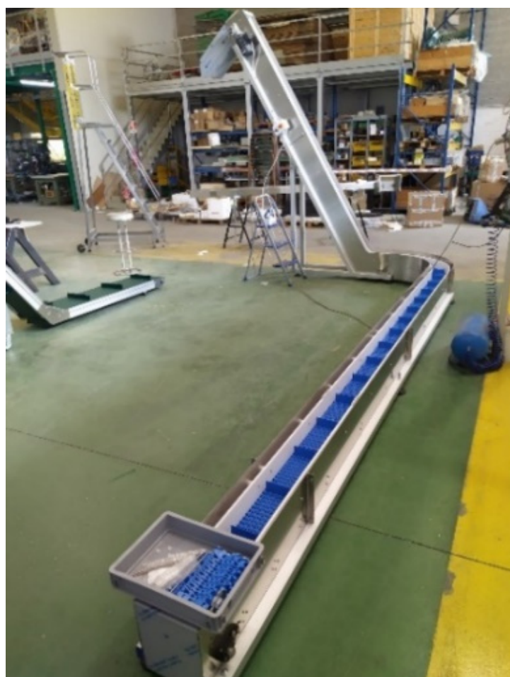
Nastro curvo AISI con tappeto in modulare per carico confezionatrice di ghiaccio in cubetti
