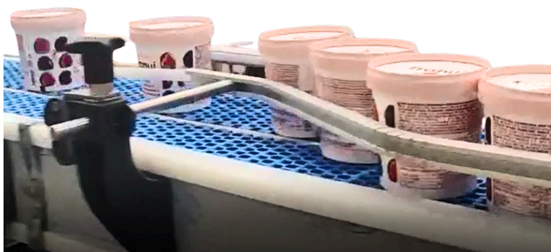
Sistema di nastri con entrata/uscita a penna d=6mm + tela modulare
