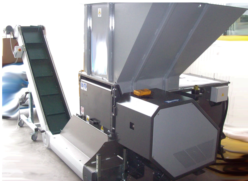
Nastro trasportatore curvo snodato per evacuazione materiale plastico da granulatore
