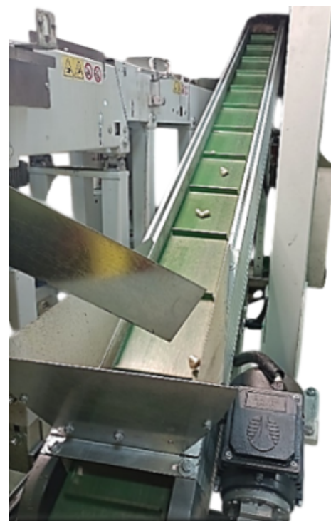
Nastro per scarico centro di lavoro
