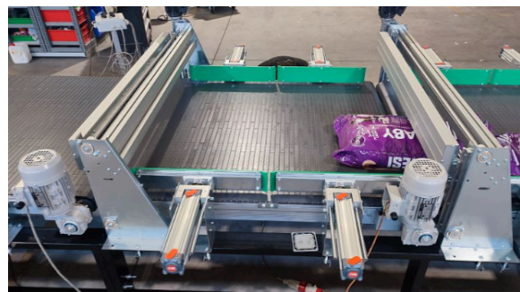
Trasporto sacchi da 20kg a 50mt/min con compattatore e stopper
