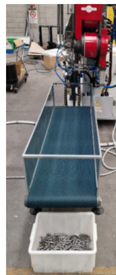
Nastro piano In AISI 1200x40mm-Tela PU Verde integrato in Macchina piega tubi
