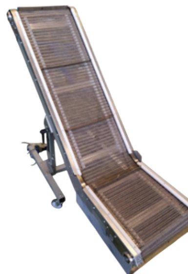
Nastro per trasporto componenti caldi a 180°
