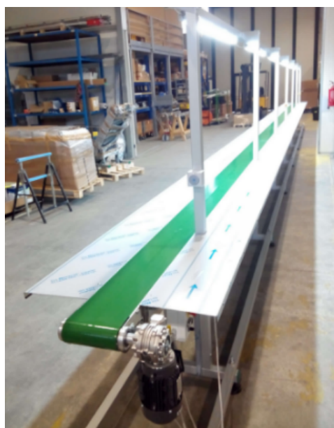
Nastro trasportatore per assemblaggio cosmetici, 15000mm INOX
