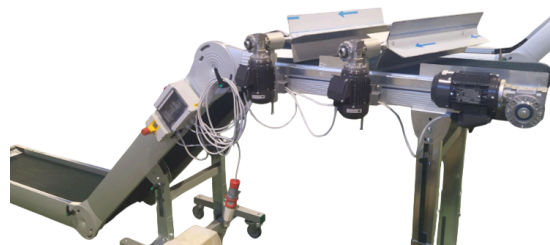
Nastro con separatori, settore trasformazione materie plastiche
