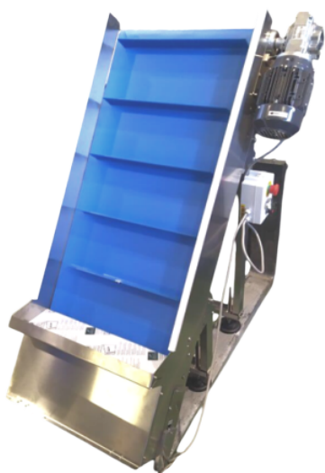
Nastro inclinato totalmente in AISI per settore alimentare
