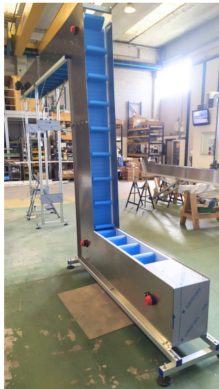
Elevatore in AISI con tappeto modulare
