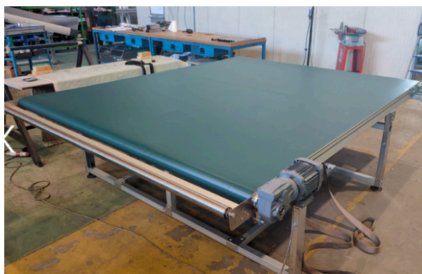
Nastri larghi 2300mm per asservimento trancia/punzonatrice lastre di acciaio
