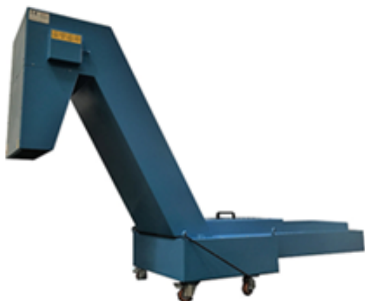
Evacuatore di truciolo a tapparella incernierata (adatto a trucioli lunghi di vari materiali) completo di pompa per liquido refrigerante ad alta portata, con 4 ruote girevoli (due con freno) per facilitarne l'inserimento all'interno della macchina utensile.
